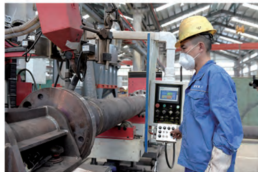
定制钻杆自动焊接机器人 Customized drill pipe automatic welding robot
