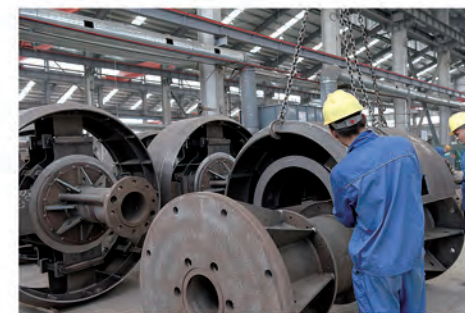
组装中的钻头导向器 Drill guide in assembly
