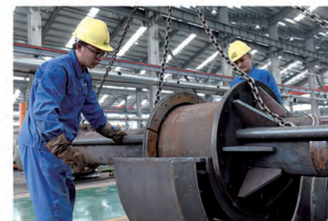
组装中的钻杆扶正器 Drill pipe centralizer in assembly
